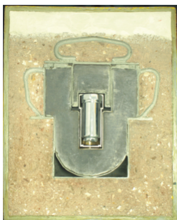
Rys. 23.3: Przygotowany do przechowania pojemnik na zużyte igły radowe. Igły wkłada się do pojemniczka stalowego, który jest otoczony grubą warstwą ołowiu, ta zaś betonem i ziemią okrzemkową. Grubość stalowej obudowy pojemnika wynosi 5 mm, zaś waga całości – ok. 100 kg
