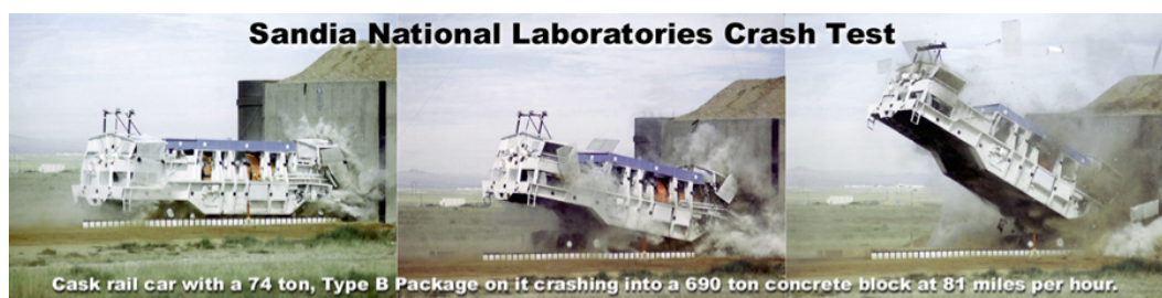
Rys. 23.18: Przebieg testu zderzeniowego pojemnika typu B umieszczonego na lorze kolejowej o wadze 74 ton ze ścianą betonową o wadze 690 ton przy prędkości pociągu ok. 130 km/godz.
