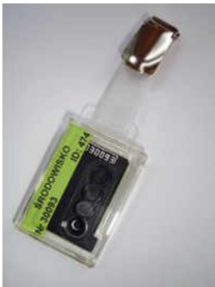
Rys. 7.3: Dawkomierz indywidualny (napis „środowisko” zamieszczony na etykiecie świadczy, że to dawkomierz środowiskowy, nie indywidualny)
