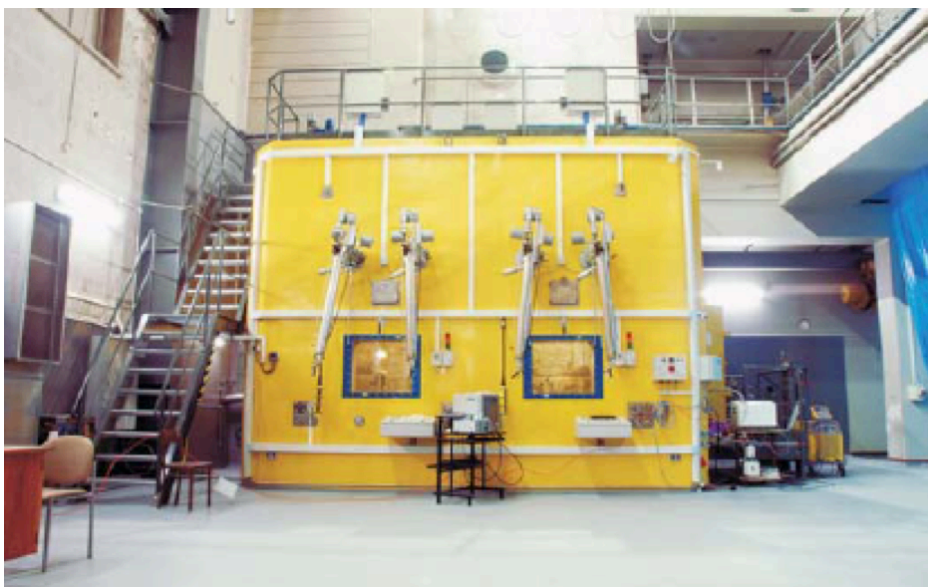
Rys. 23.12: Komory do kapsułowania wypalonego paliwa w hali byłego reaktora Ewa
