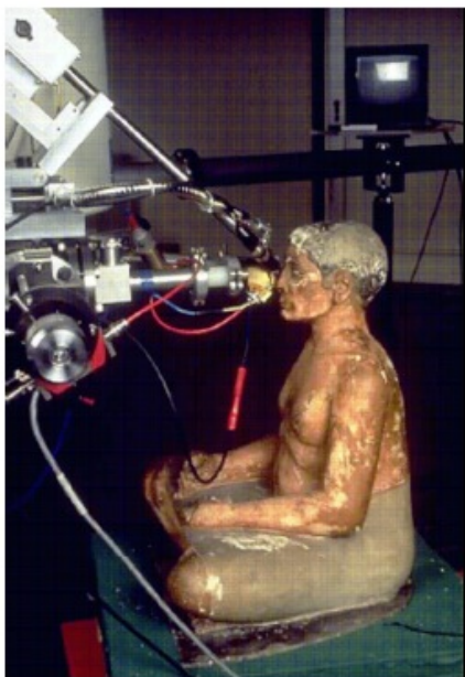
Rys. 21.10: Widok stanowiska do badania metodą PIXE polichromii na figurce z Ameryki Środkowej [źródło: Larry Lam, Applications for PIXE and other ion beam analyses (IBA), PIXE PAN Summer Science Program, University of Notre Dame, June 2007]
