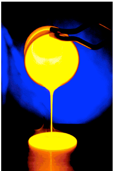
Rys. 23.14: Szklana masa wlewana jest do stalowych pojemników
