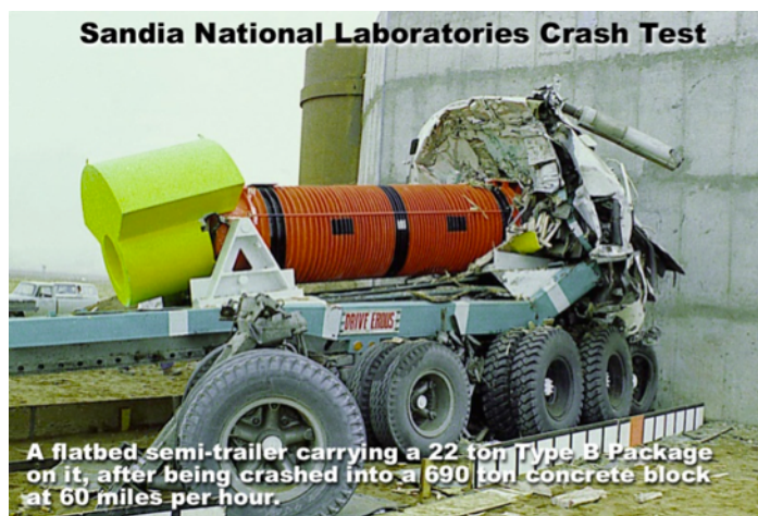
Rys. 23.20: Test zderzeniowy dla ciężarówki wiozącej pojemnik o wadze 22 ton, zderzający się przy prędkości ok. 100 km/godz. ze ścianą betonową ważącą 690 ton
