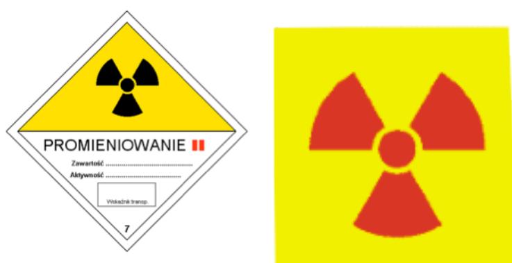
Rys. 23.17: Typowe nalepki ostrzegawcze na pojazdach transportujących odpady promieniotwórcze
