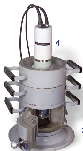
Rys. 1 (1 - zasilacz ZWN-21, 2 - dyskryminator DP-21, 3 - domek osłonowy, 4 - detektor G-M ze zintegrowanym wzmacniaczem)
